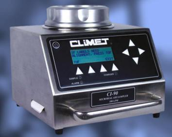
Le CI-90A a un boîtier en acier inoxydable avec une imprimante thermique d'étiquettes intégrée. Il s'agit d'un échantillonneur microbien d'air actif utilisé dans des applications de surveillance séquentielle ou continue dans les zones aseptiques.
