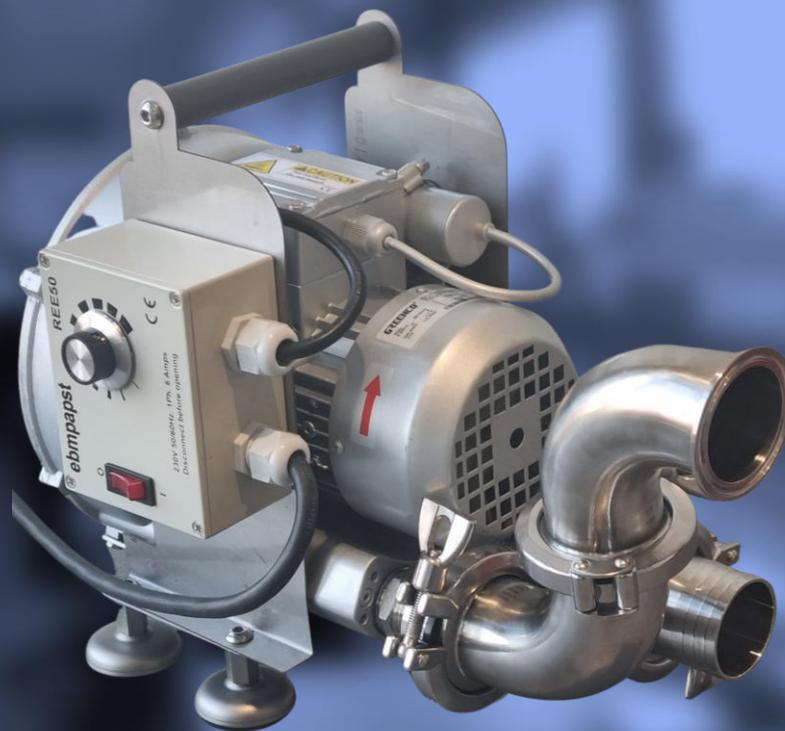
Cette pompe va permettre à l'utilisateur d'acheminer facilement et sans émissions de fumée, l'aérosol généré jusqu'au point d'injection. Elle fonctionne avec tout générateur thermique ou pneumatique. La pompe est fournie avec un ensemble de raccords triclamp en Inox 316L et se connecte au choix sur un flexible diamètre 50 ou 32 mm.
