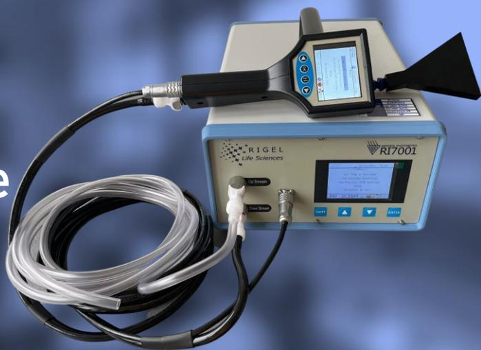
Basé sur la diffraction de la lumière blanche, le RI7001 détermine en temps réel l'intégrité du filtre suite à la détection de la concentration d'aérosol en amont puis au balayage en aval du filtre.
