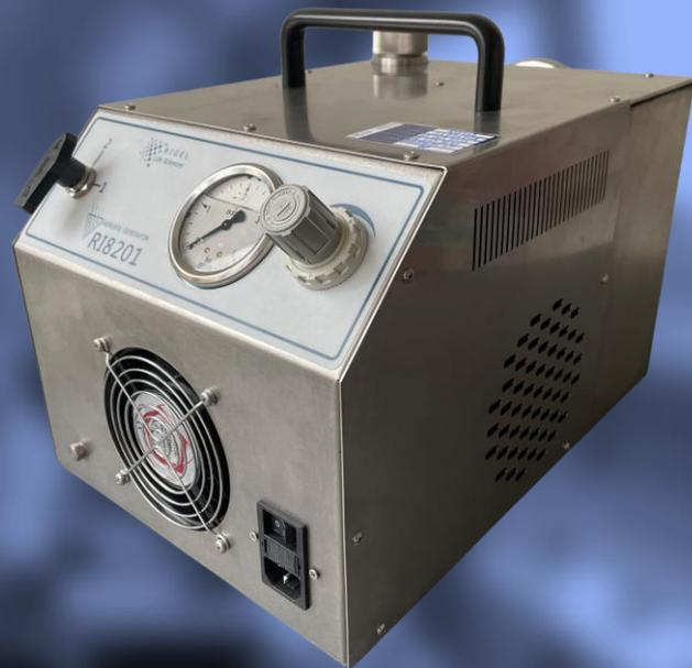
Le Rigel RI8201 est un générateur à froid portable avec compresseur intégré conçu pour les tests d'intégrité des PSM, isolateur, FFU, plafonds laminaires, etc
